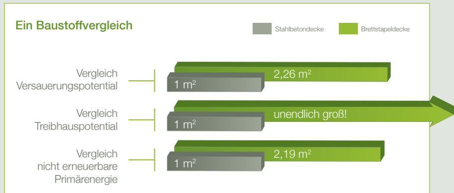
Die Produktion einer Brettstapeldecke mit einer Fläche von 2,26 m<sup>2</sup> verursacht in etwa dieselbe Versauerung wie die Herstellung einer Stahlbetondecke mit einer Grundfläche von lediglich 1 m<sup>2</sup>. Ähnliches gilt bei der Betrachtung der nicht erneuerbaren Primärenergie. Holz leistet keinen Beitrag zum Treibhauseffekt, wodurch es bei diesem Umweltkriterium im Vergleich zu Stahlbeton sowieso unschlagbar ist.
