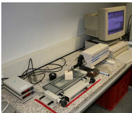
Abbildung 6 - Oberflächenanalysegerät Form Talysurf (2) 50i (links), Taster mit Diamantspitze auf einer Probenoberfläche (rechts)
