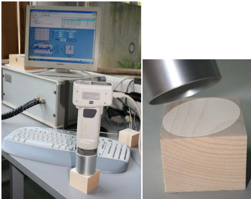
Abbildung 3 - Messgerät Chroma-Meter CR-410 (links) mit einer kreisförmigen Messfläche - Durchmesser 50 mm (rechts)
